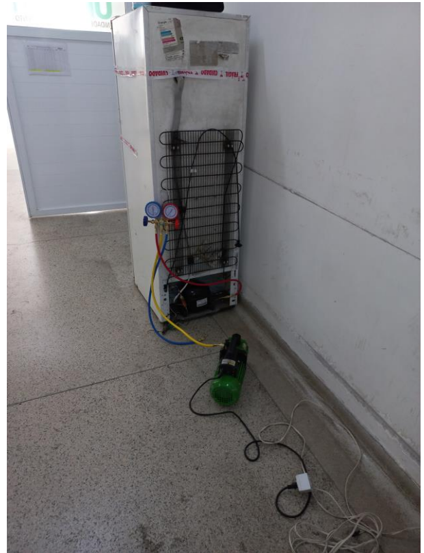
16/01 – Substituição de motor queimado e conserto geladeira repouso dos médicos
